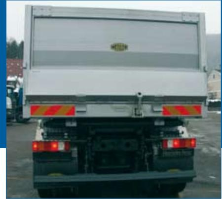
Rückwandklappe aus Spezialstahl pneum. betätigt; MEILLER-Unterfahrerschutz klappbar (Sonderausstattung)
