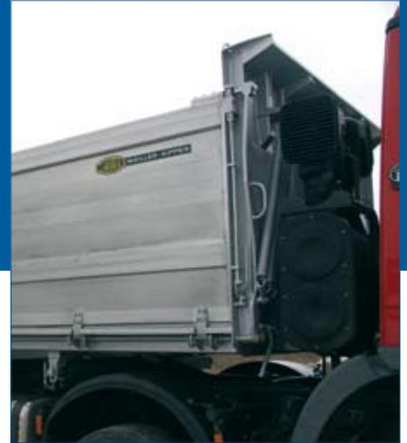
Bordwand rechts, abklapp- und pendelbar mit Federschließhilfe
