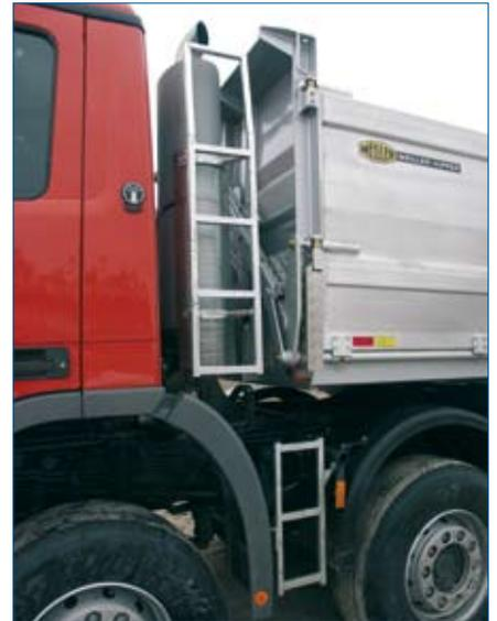
Stirnwand mit Fahrerhausschutzdach, Bordmatik-Zylinder und Aufstiegsleiter
