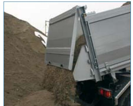
seitliche Schüttgutbleche abnehmbar, leicht zugänglich befestigt am Alu-Kotflügel
