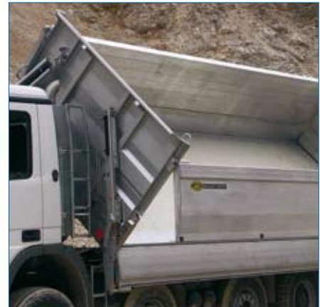
Alu-Bordwand links, Unterteil abklappbar mit hydr. Bordmatik, Oberteil pendelnd
