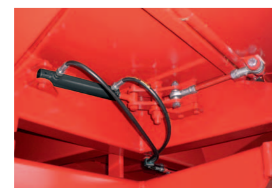
Die hydraulische Entriegelung der seitlichen Bordwände kann bequem vom Schleppersitz aus erfolgen. Der Übertotpunkt-Verschluss sichert gegen unbeabsichtigtes Öffnen.
