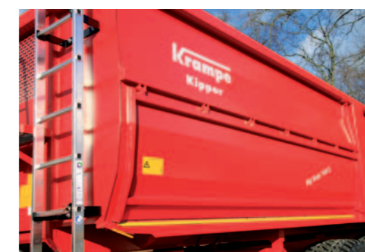
Die seitlichen Bordwände werden auf ganzer Länge mit einer Anpresslippe korndicht abgedichtet. Der alte Schließhaken hat bei uns schon lange ausgedient.
