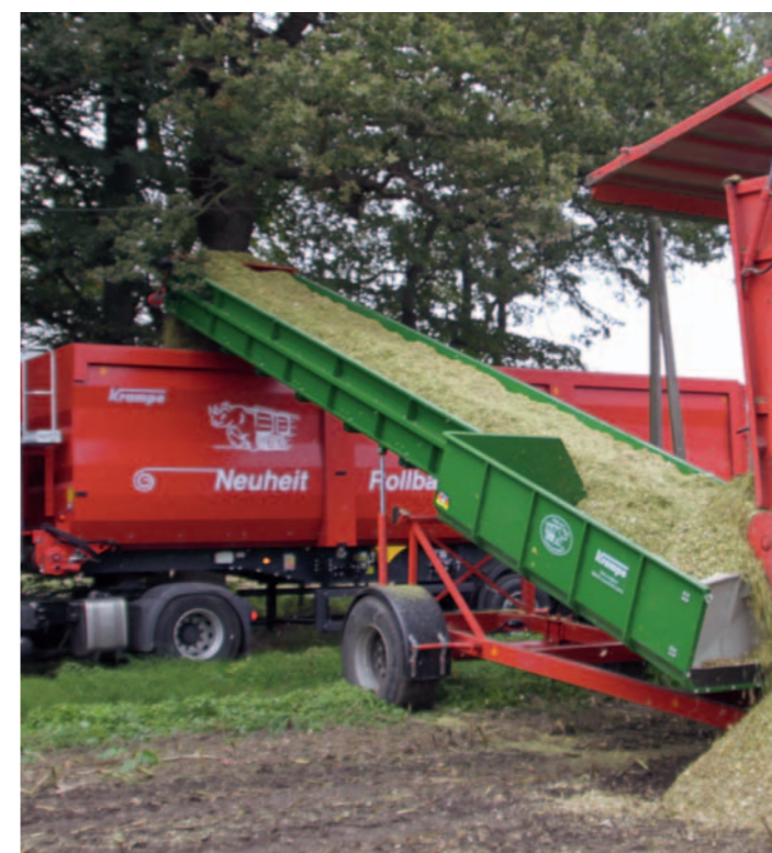
Mit dem hydraulisch angetriebenen Überladeband kann das Erntegut direkt vom Feldrand auf Straßenfahrzeuge umgeladen werden.
