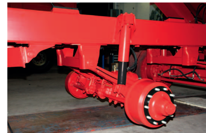
24 t Parabelfedern mit Längslenkern, Achsabstand 1,55m.
