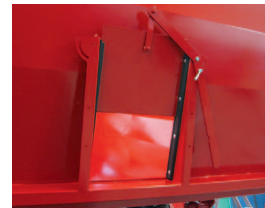
Alle Wannenkipper haben einen leichtgängigen Auslaufschieber (46x34 cm), der in Kunststoffführungen läuft. Der Öffnungshebel ist wahlweise rechts oder links montierbar.
