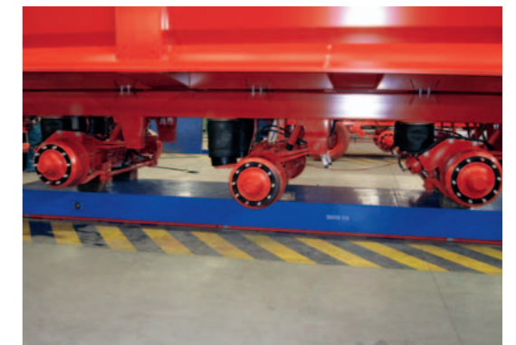
Fahrwerke mit Luftfederung sorgen für einen ausgesprochen ruhigen Lauf.
