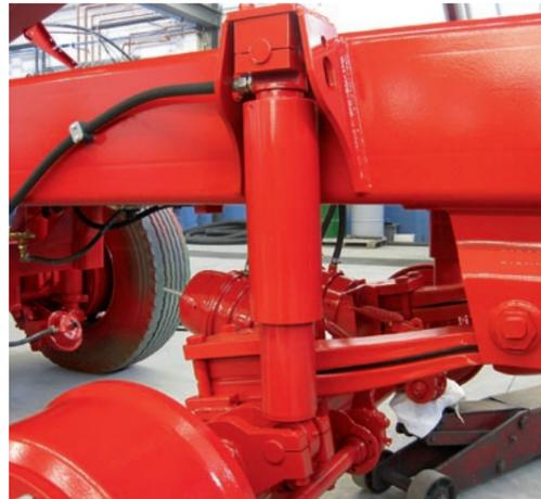
Alternativ bieten wir hydraulisch gefederte Fahrwerke an, die eine hervorragende Standsicherheit bieten, gerade bei Aufbauten mit einem hohen Schwerpunkt und enger Federmitte. Nutzen Sie unsere langjährigen Erfahrungen im Bau von hochwertigen Fahrwerken. Wir zeigen, wo's langgeht!
