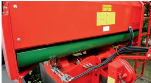
An der Stirnwand und am Heck rollen kraftvolle Hydro-Motoren das Rollband je nach Ladevorgang auf oder ab.
