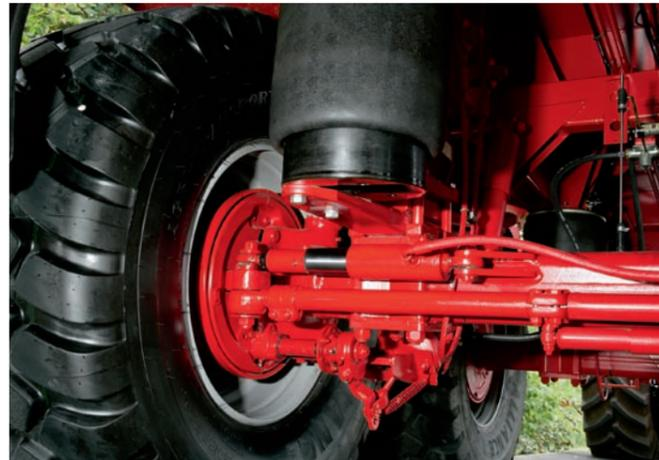
Als Option ist eine Luftfederung lieferbar, die für ein ruhiges und besonders komfortables Fahrverhalten sorgt. Der große Federweg ermöglicht eine gute Geländegängigkeit. Dadurch wird auch ein geringer Zugkraftbedarf ermöglicht, keine Achse bohrt sich in den Boden, denn auf jeder Achse liegt immer die gleiche Last.
