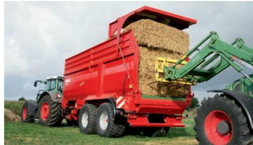
Beladen kinderleicht gemacht: Mit der serienmäßigen Funk-Fernbedienung kann der Bandvorschub bequem vom Lader aus bedient werden.
