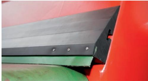
Dichtlippen sorgen an den seitlichen Bordwänden dafür, dass kein Ladegut in die Rollbandführung gelangt.
