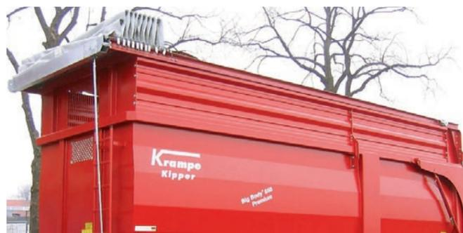
In vielen Bundesländern ist die Abdeckplane schon zur Pflicht geworden. Wir bieten verschiedene Systeme an, von der einfachen Rollplane über die Schrägdachplane bis hin zum luxuriösen Schiebeverdeck à la LKW.
