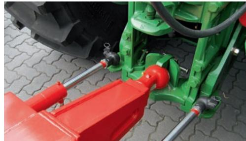
Neben den Nachlauf-Lenkachsen bieten wir seit vielen Jahren zwangsgelenkte Achsen an. Diese lenken auch bei Rückwärtsfahrt spurtreu mit. Das Schlingern bei schneller Straßenfahrt oder im abschüssigen Gelände unterbleibt, die Verkehrssicherheit wird dadurch erhöht. Räder und Chassis werden geschont.
