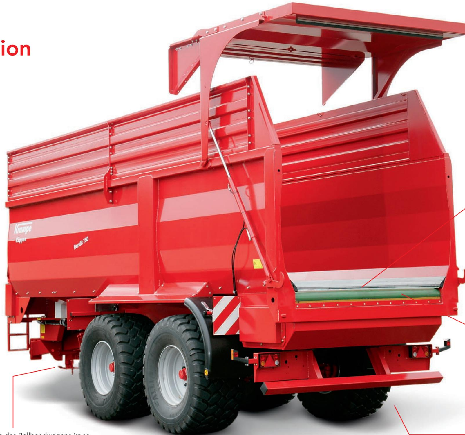
Der Rollbandwagen Bandit verfügt über die gleiche Heckklappe wie alle Wannenkipper der erfolgreichen BigBody-Serie. Keine Volumenheckklappe, mit der krampfhaft versucht wird, die Ladefläche zu verlängern und die beim Öffnen hoch in den Himmel ragt. Solide gebaut, kann der Bandit seine Klappe auch in niedrigen Hallen öffnen und erleichtert so das Handling von Ladegütern aller Art.
