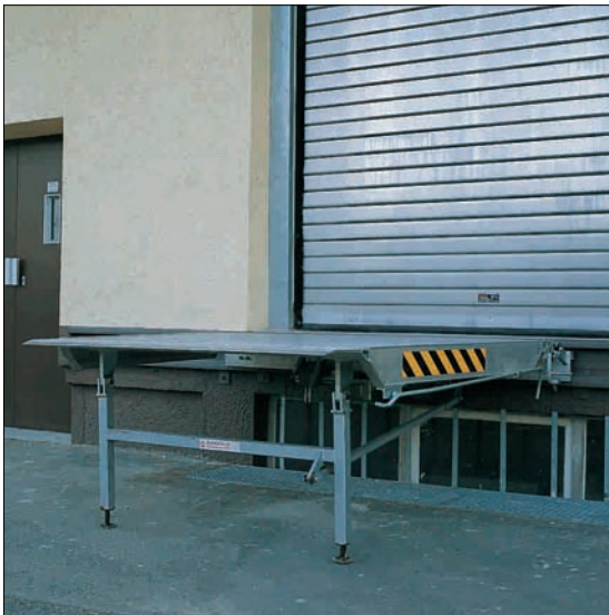
federmech. Verladebrücke mit konischer Plattform und zwangsgeführtem einstellbarem Pendelstützfuß ▲
