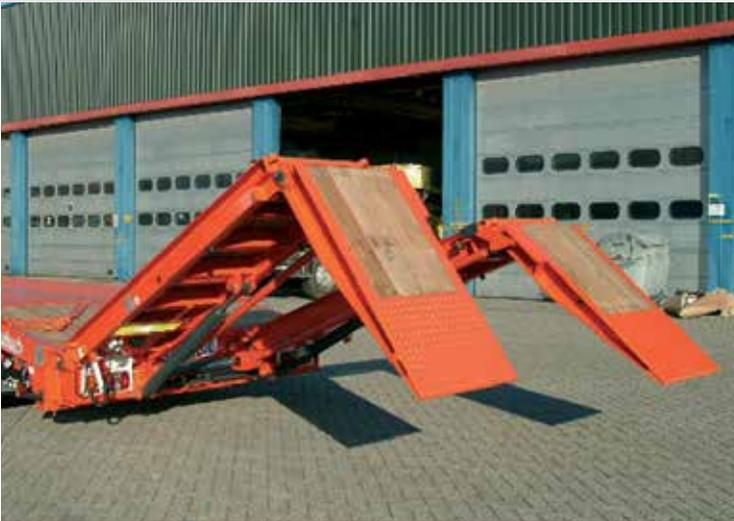
**Hydraulische 5-meter Faltrampen**
