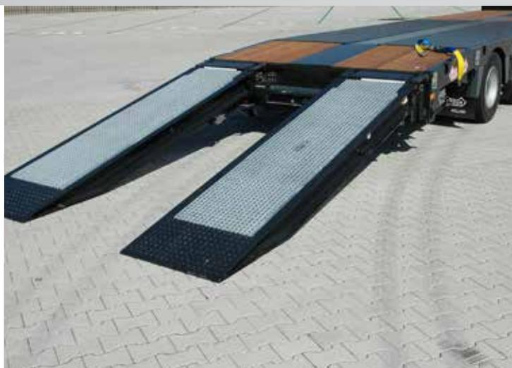
**Hydraulische 3-meter Rampen**
