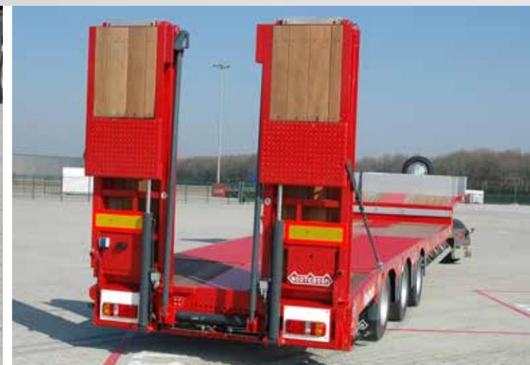
**Hydraulische 4-meter Faltrampen**
