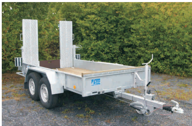
Ges.-Gew. 2100 kg , Bestellnr. 414/2100, NL ca. 1570 kg, Lademaß innen ca. 3000x1600 mm, Ladehöhe unbeladen ca. 540 mm, gerade Deichsel mit PKW-Kugelkopfkupplung, Zubehör: Auflagebock
