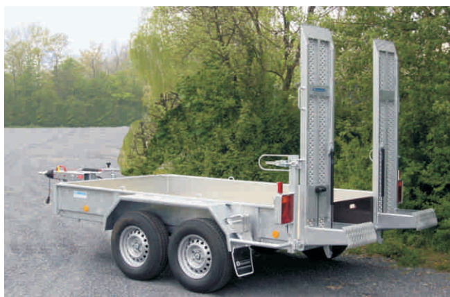
Ges.-Gew. 3150 kg , Bestellnr. 434/3150, NL ca. 2400 kg, Lademaß innen ca. 3000x1700 mm, Ladehöhe unbeladen ca. 560 mm, Zubehör: Zugeinrichtung stufenlos höhenverstellbar mit LKW-DIN -Zugöse
