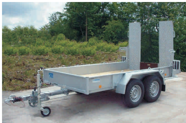
Ges.-Gew. 2750 kg , Bestellnr. 428/2750, NL ca. 2150 kg, Lademaß innen ca. 3000x1600 mm, Ladehöhe unbeladen ca. 540 mm, gerade Deichsel mit PKW-Kugelkopfkupplung
