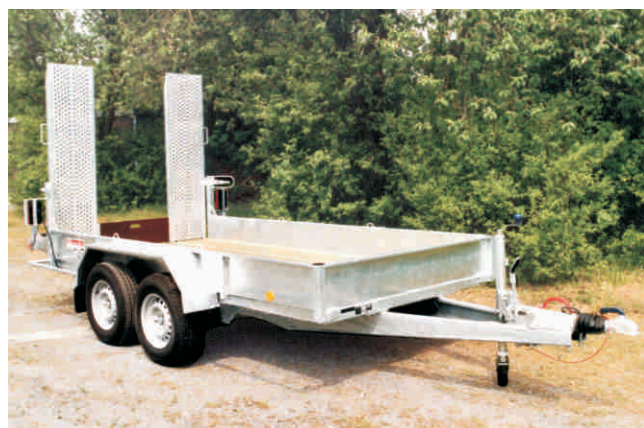
Ges.-Gew. 3500 kg , Bestellnr. 441/3500, NL ca. 2700 kg, (alternativ 3650 kg Ges.-Gew. mit 2850 kg Nutzlast), Lademaß innen ca. 3000x1700 mm (alternativ Lademaß 3500x1700 mm oder 3500x1900 mm), Ladehöhe unbeladen ca. 560 mm, V-Deichsel mit PKW-Kugelkopfkupplung
