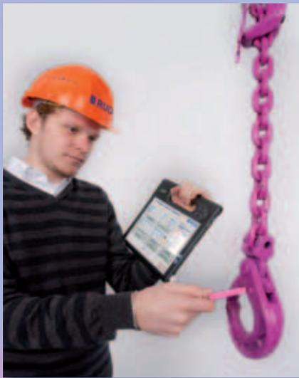
Vorgeschriebene regelmäßige Überprüfungen von Lastaufnahmemitteln (vgl. BetrSichV § 2) sind momentan noch aufwändig und oft fehleranfällig.
