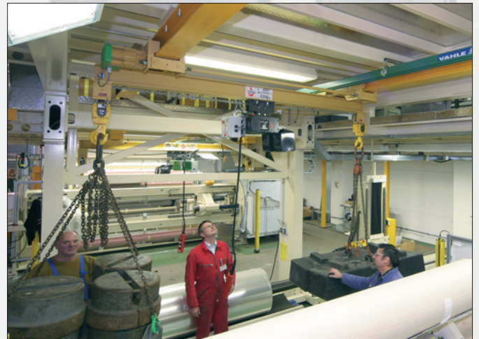
Sonderkran mit 2 x 1,6 t Synchron-Hubwerk
