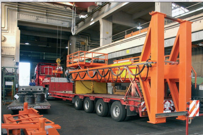
3,2 t Zweiträger-Konsolkran mit 9 m Ausladung
