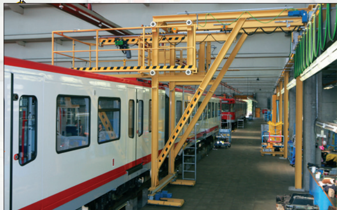
0,6 t Halbportalkran mit Ausschleibe-Brückenträger und ausschiebbarer Arbeitsbühne
